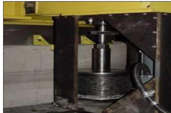
Abbildung 13: Grindingvorrichtung [3]
