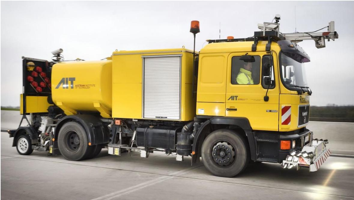
**Abbildung 24: Messfahrzeug RoadSTAR zur Erfassung von Griffigkeit, Längs- und Querebenheit.**
