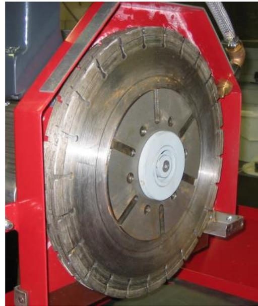
Abbildung 33: Laborgrindingmaschine
