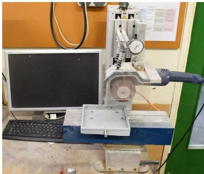
**Abbildung 34: Walzenpoliermaschine**
